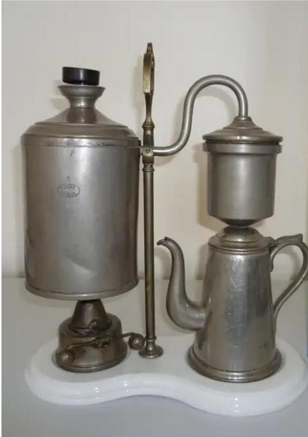
Brenners, der durch den Wasserbehälter gehalten wird, zu. Er löscht die Flamme. So überhitzt sich nichts bei der Sicherheitskaffeemaschine.“
